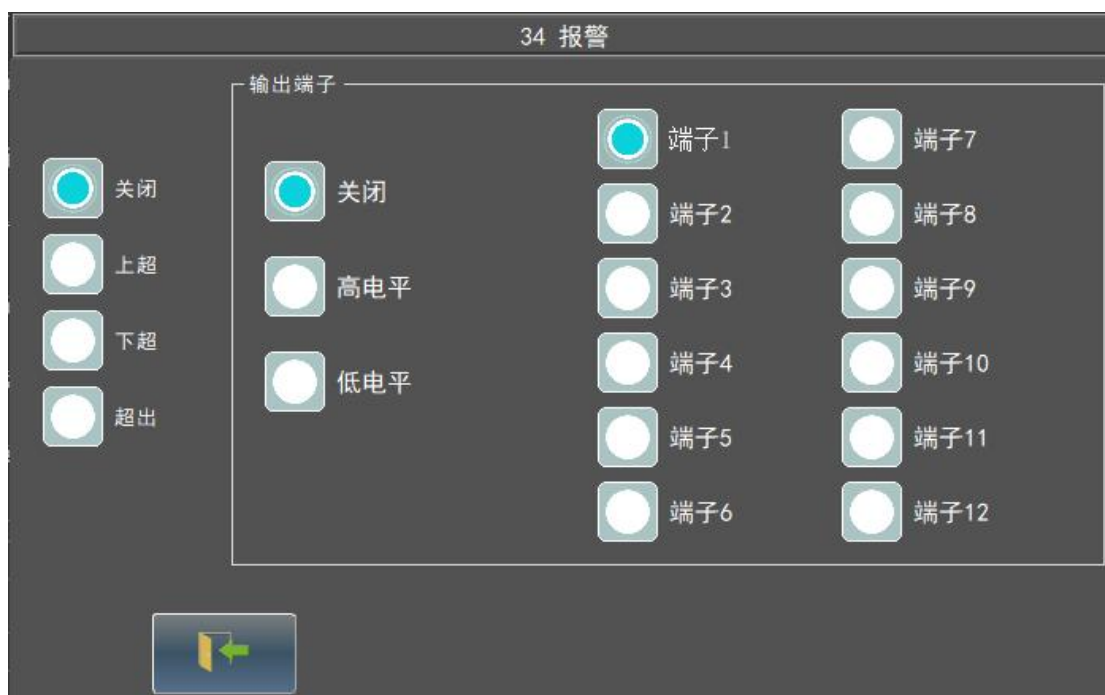
设置通道报警的判断条件及报警输出的端子号和输出信号类型
